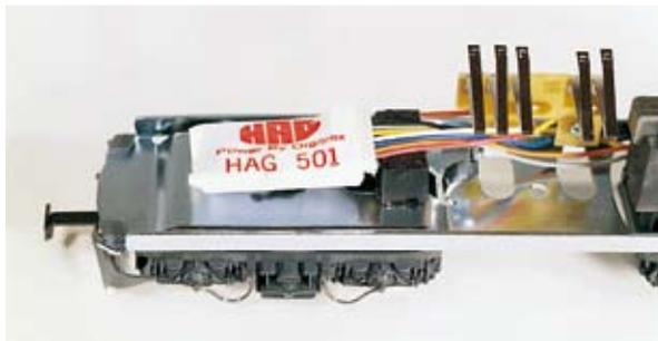
Und so wird der HAG-Decoder am einfachsten montiert: Man nehme ein rechteckiges Hartgummi-Klötzchen (Art.Nr. 501 013-75), belege es unten und oben mit beidseitigen Klebestreifen und klebe das Ganze so auf den Lok-Boden, dass der Kabelbaum des Decoders gleich hinter dem Stecker auf dem Klötzchen aufliegt. Positiver Nebeneffekt: Der Decoder steht frei in der Luft und wird entsprechend gut gekühlt.
