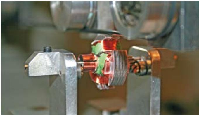
Ein Rotor im Sensorenlager: Ljiliana wuchtet ihn mit grünem Kitt aus, der also später keinesfalls aus der Wicklung entfernt werden darf!
