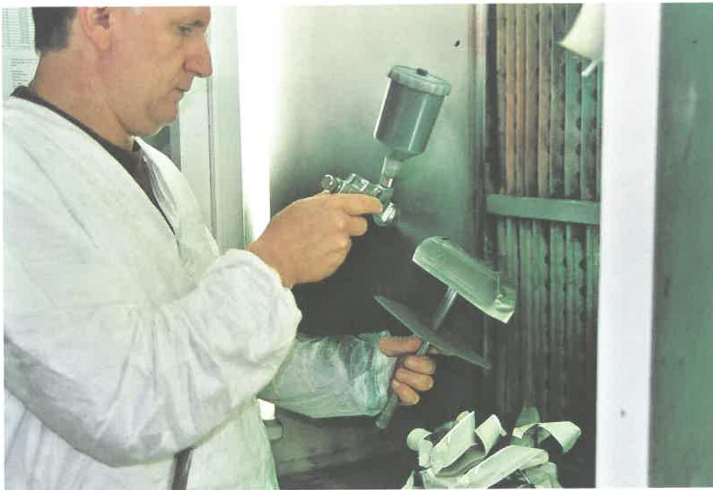
*Zivorad Jankovic am Drücker: Die Arbeit mit der Spritzpistole verlangt Fingerspitzengefühl, weil der Lack möglichst dünn, aber doch deckend aufgesprüht werden muss.*
