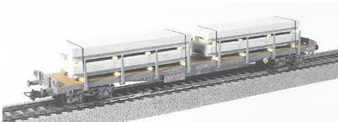
SBB Flachwagen mit Klappungen, Typ Rs mit Beton-Platten
