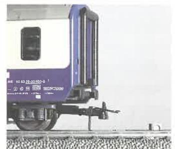
Die Lösung: Der lange, nach unten hängende Lappen, meist aus geschwärztem Feiblech, lässt sich mit einem Seitenschneider leicht um 1 bis 2 mm kürzen. Die Entkupplungsfunktion bleibt gewährleistet – wenn Sie nicht zuviel abschneiden.
